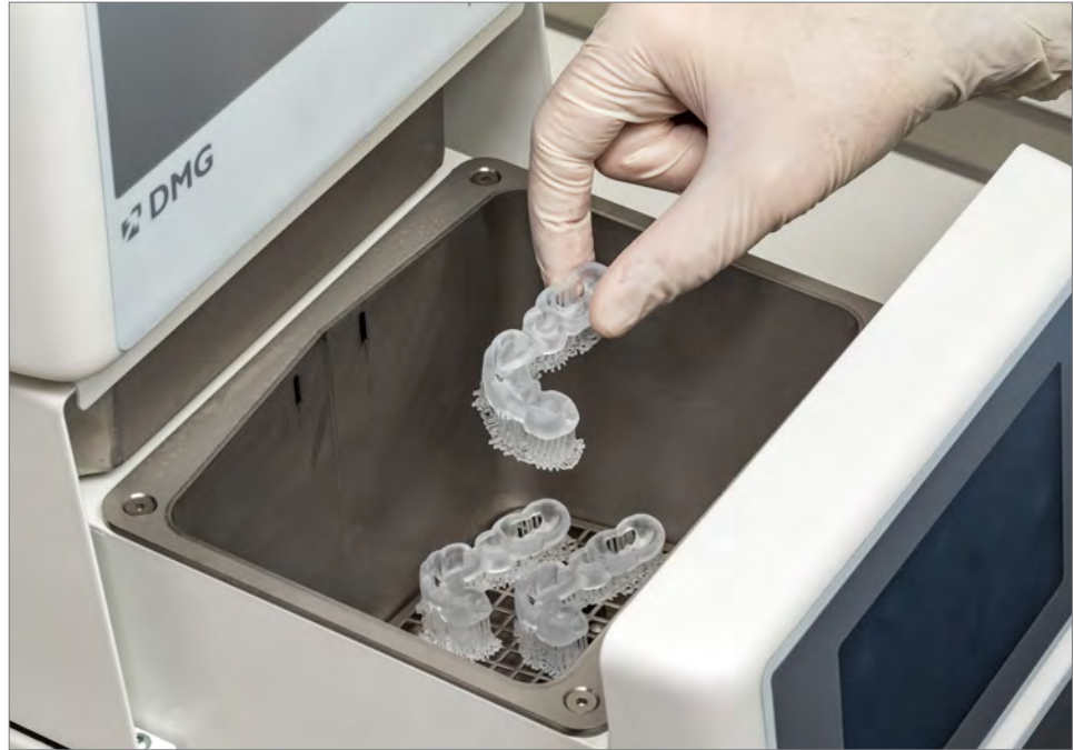
Abbildung 18: Bohrhülse in der Einheit 3Dewash
