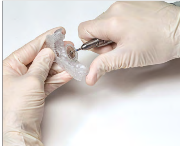
Abbildung 22: Entfernen der Stützstrukturen mittels Trennscheibe
